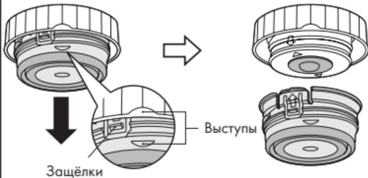
Чтобы разобрать крышку-пробку, отсоедините внутреннюю часть пробки – удерживая её пальцами с двух противоположных сторон за выступы, потяните пробку вниз.
