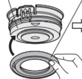
Чтобы снять нижнюю прокладку с внутренней части пробки, возмитесь за ее край и потяните вниз.
