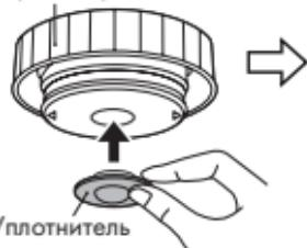
Чтобы снять уплотнитель верхней крышки, отогните его край и потяните, чтобы извлечь из отверстия на нижней части крышки.
