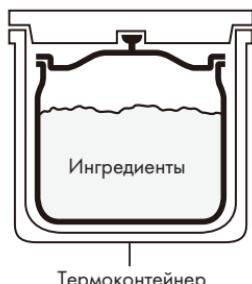
Оставьте термоконтейнер закрытым на 1-2 часа (в зависимости от ингредиентов и объема заполнения внутренней кастрюли). Термоконтейнер сохранит блюдо горячим более 6 часов. Снимите крышку термоконтейнера, извлеките внутреннюю кастрюлю и снимите стеклянную крышку.
