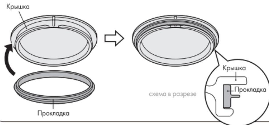
Установите прокладку на нижнюю часть крышки как показано на рисунке. Прокладка должна совпасть с пазами нижней части крышки по всему периметру. Удостоверьтесь в правильной установке прокладки и ее плотном прилегании к крышке – проведите пальцами по всей окружности прокладки с небольшим нажимом.
