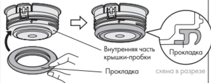
Установите прокладку плоской поверхностью к нижней части крышки-пробки и, слегка растягивая, наденьте таким образом, чтобы пазы прокладки совпали с выступами на нижней части пробки. Аккуратно проведите пальцами по всему периметру прокладки, для её полного прилегания к основанию пробки.
