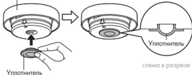
Для установки уплотнителя плотно вставьте его в углубление на нижней части крышки-пробки так, чтобы не осталось щелей, нажав на выпуклую часть уплотнителя.
