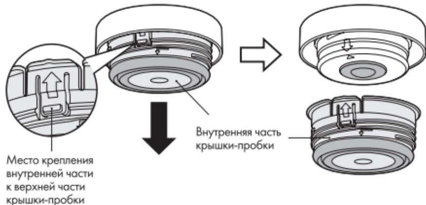
Место крепления внутренней части к верхней части крышки-пробки
